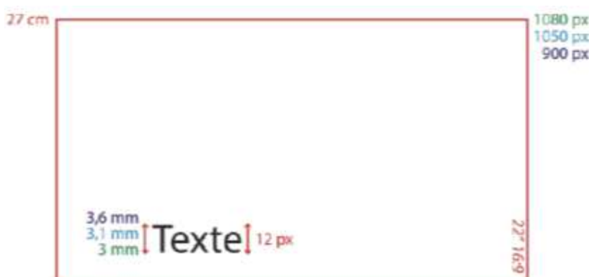
Figure 10 : Taille verticale d’un texte en corps 12 px selon la définition verticale d’affichage
